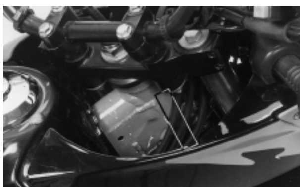
(1) O número de série do chassi está gravado no lado direito do tubo da coluna de direção.
