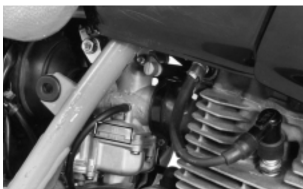
(3) O número da identificação do carburador está localizado no lado direito do corpo do carburador.
